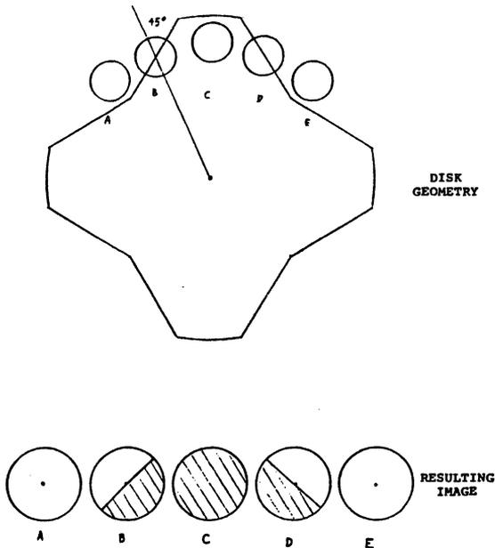
Figure 1. OPERATION OF SCANNING DISK
